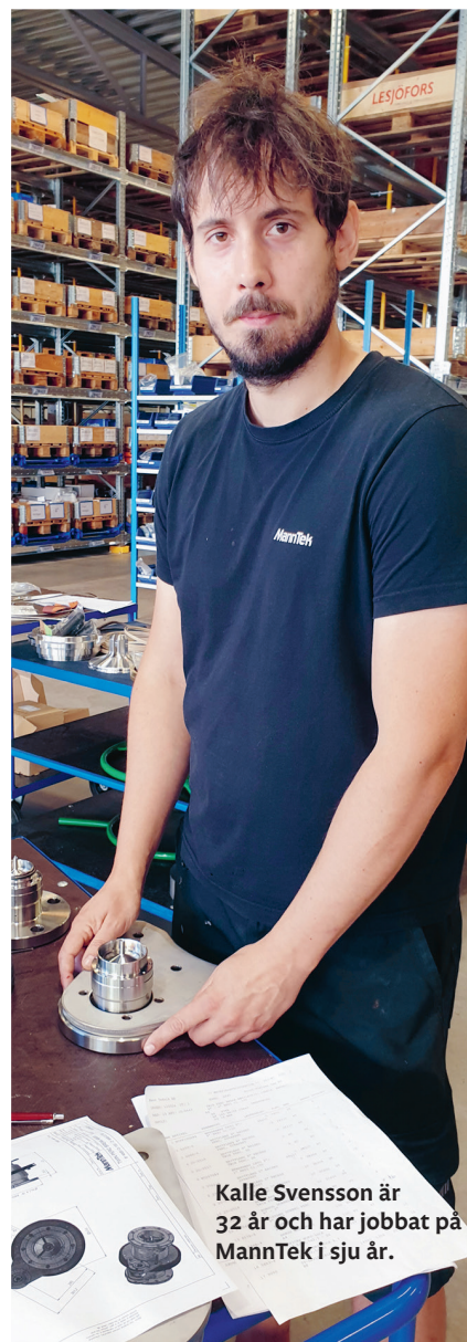
Break-way koppling som släpper vid problem för att undvika läckage.
