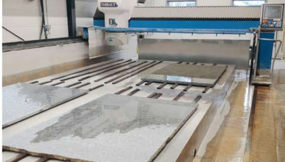
En automatiserad slipmaskin där de kan få plats med fyra skivor samtidigt.
