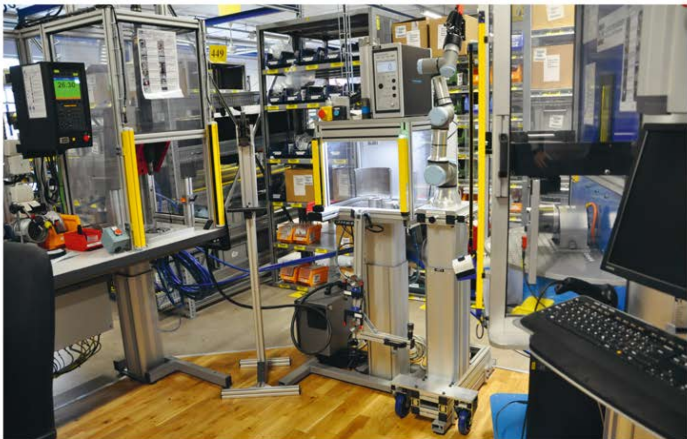
Robotarna är på hjul för att lättare kunna ställa om från robot till människa vid behov.
