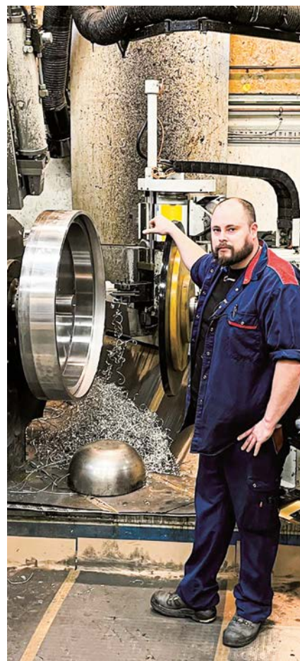
Bild 1. Förenklat kan trycksvarvning liknas vid drejning. Här formas materialet mot en matris eller patron.
