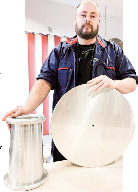
Bild 1. Förenklat kan trycksvarvning liknas vid drejning. Här formas materialet mot en matris eller patron.
