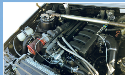
Erik har förvandlat Volvons motor till ett krutpaket, bland annat med hjälp av en 70 mm turbo.
