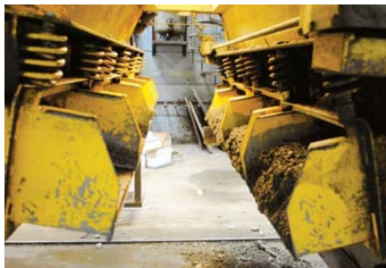
Vagnar med betong tömmer sin last rakt ner i de vaxbestrukna formarna där den sedan fördelas jämt. Armering och isolering fylls snabbt upp och elementet rullar sakta vidare på sitt band.
